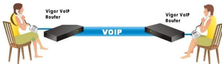
Nos modèles Vigor V mettent d'abord en œuvre des codecs efficaces conçus pour utiliser au mieux la bande passante disponible. Ils sont également dotés d'une fonction d'assurance automatique de la qualité de service. L'assurance de la qualité de service permet de donner la priorité au trafic téléphonique. Votre bande passante d'arrivée et de départ donne la priorité au trafic téléphonique mais vos données subissent un léger retard, tolérable pour le trafic de données.
